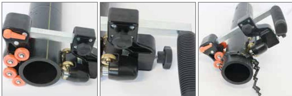
Esempio di Raschiatura Tubo D90 mm SDR11 S5 PE100 - Scraping example on pipe D90 mm SDR11 S5 PE100
