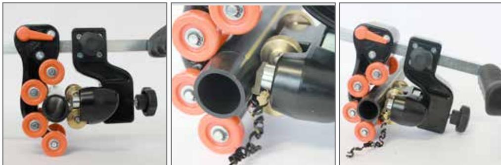
Esempio di Raschiatura Tubo D32 mm SDR11 S5 - Scraping example on pipe D32 mm SDR11 S5
